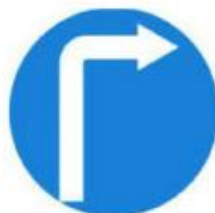
Biển Báo Hiệu Giao Thông Hiệu Lệnh R.301d Các Xe Chỉ Được Về Phải
