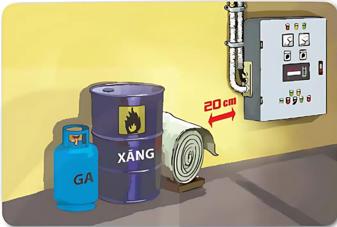
b) Chất đốt để gần tủ điện
