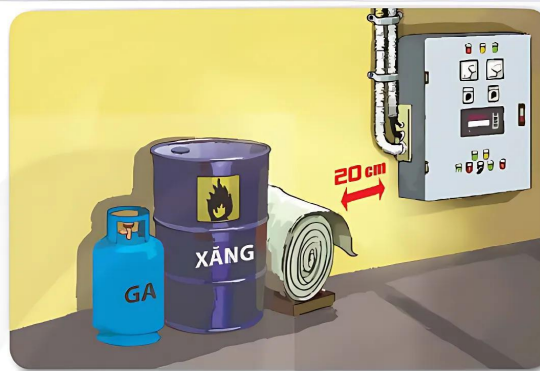
b) Chất đốt để gần tủ điện
