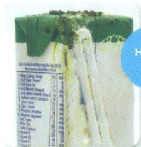
Hộp bị bắn, chảy nước
